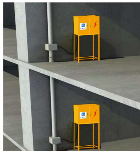
楼层电缆线敷设示意图
