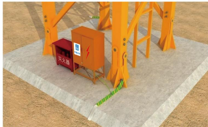
塔式起重机防雷接地示意图
