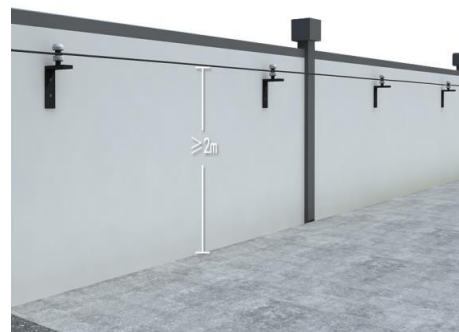
电缆线沿墙壁敷设示意图
