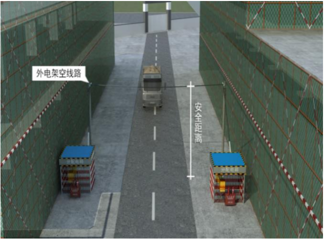
机动车道架空线路
