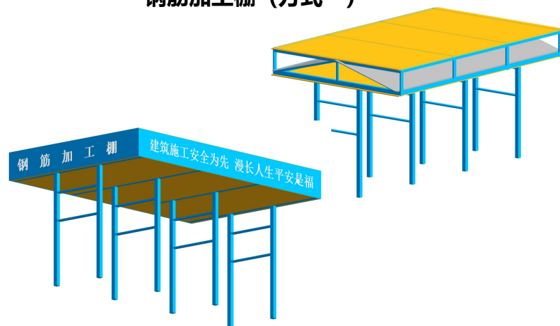
钢筋加工棚 (方式一)
