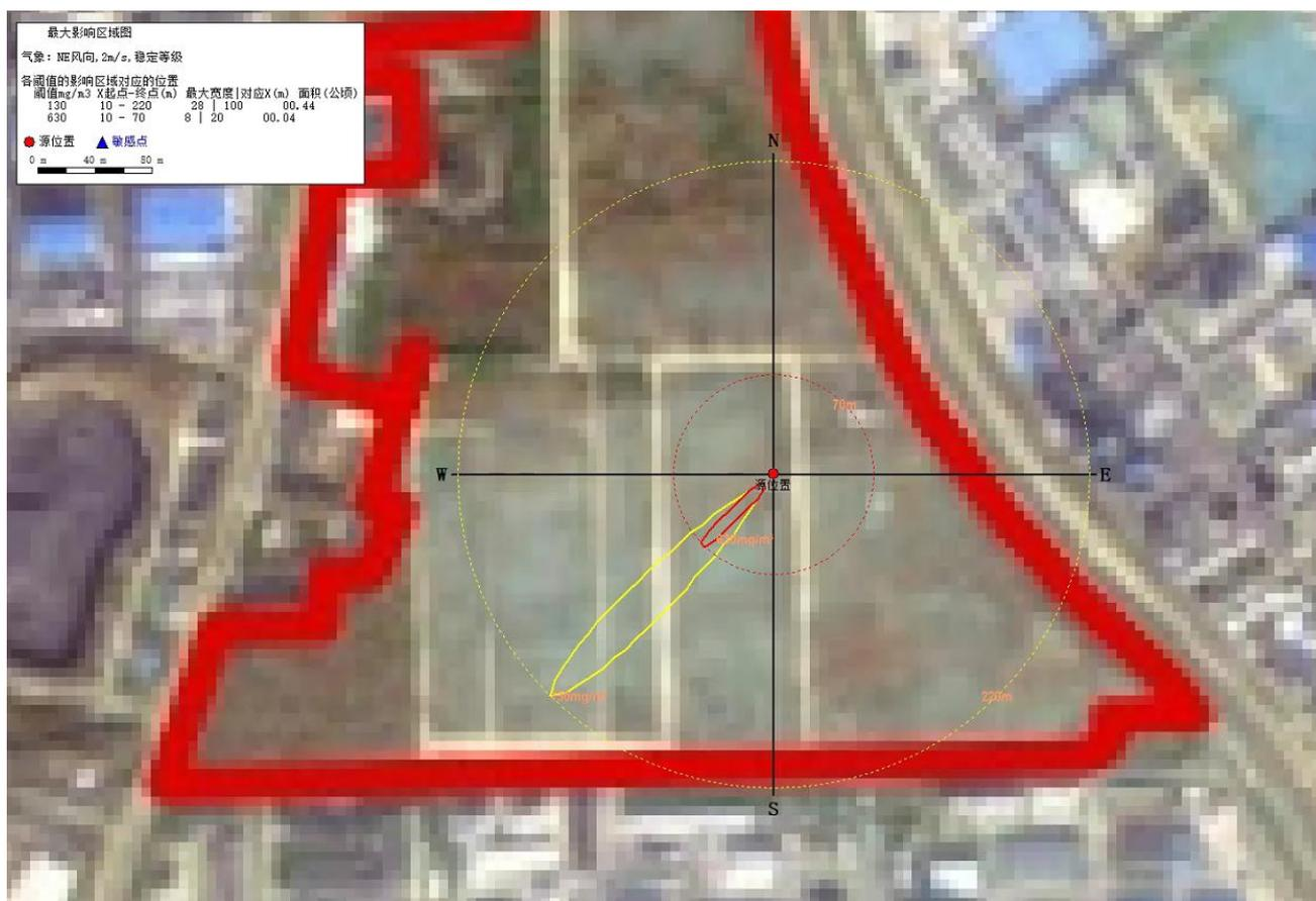
图 5.2.7-2 最不利气象条件下醋酸乙烯扩散最大影响区域图
